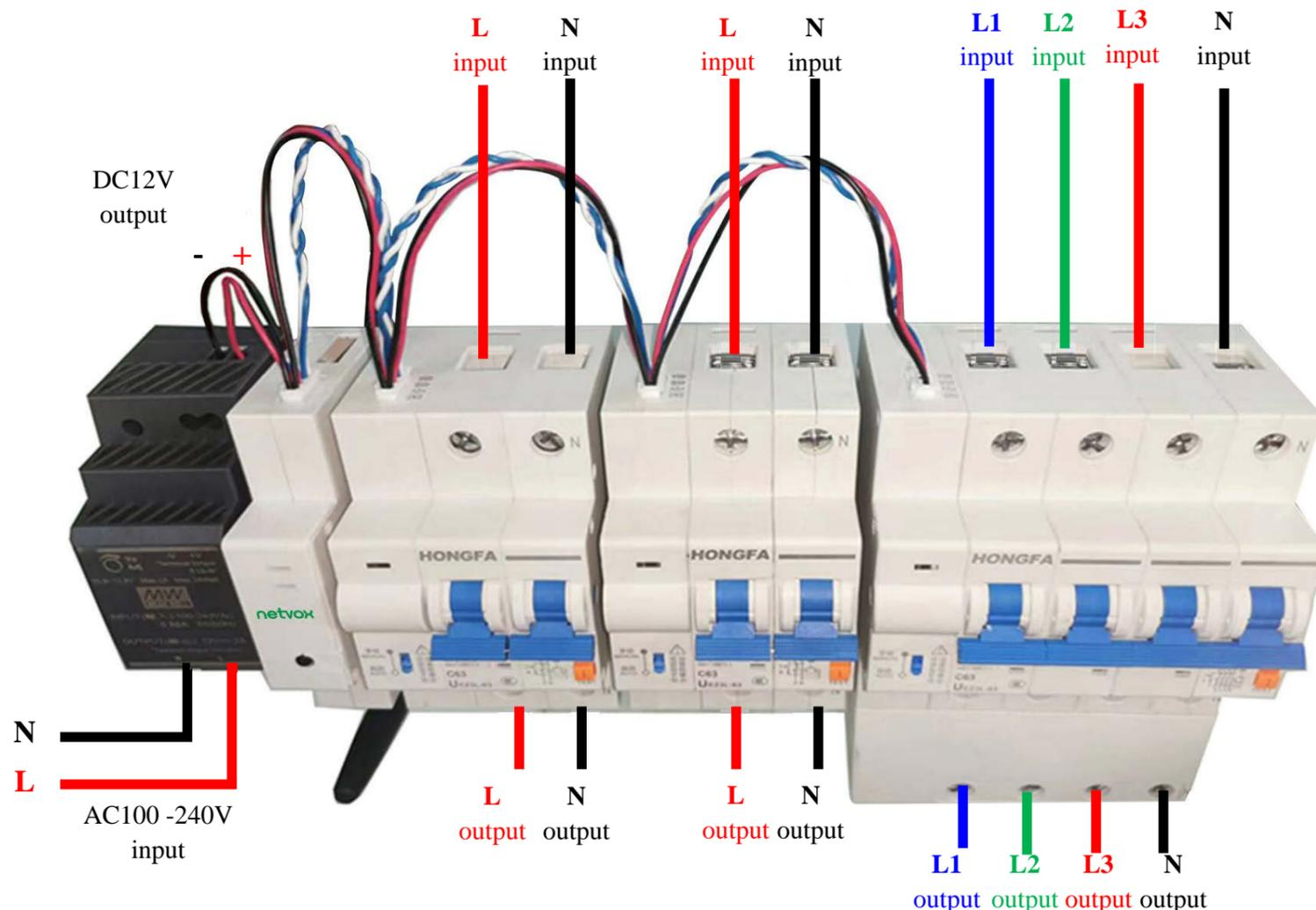
(a) Power Module + LoRa/LoRaWAN Radio Module + 1PNL\*2 + 3PNL Breaker
