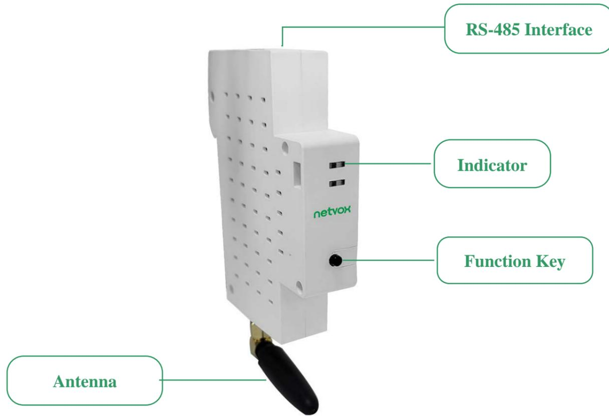
**LoRa/LoRaWAN Radio Module**
